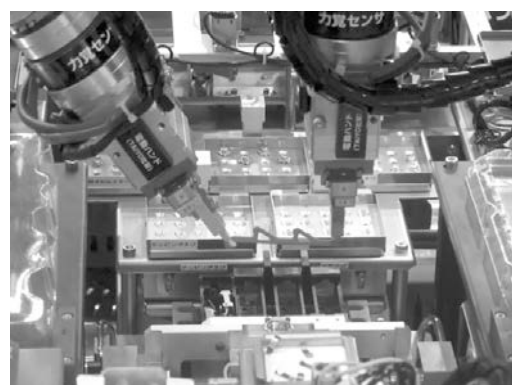
Permet de terminer les tâches de montage pendant le maintien des positions de pinces entre les robots.
